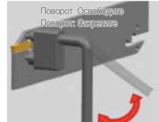
Поверните ключ и закрепите СМП, затем вытащите ключ из отверстия
