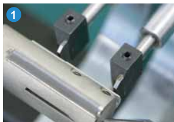
1. Установите индикаторы измерительных приборов на «0»
