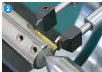
2. Вращайте развертку для определения отклонений индикатора
