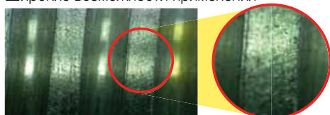
DST22 ( v_c = 100\text{ м/мин} ) Отличная обработанная поверхность
