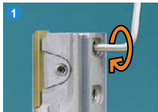
1. Плавно открутите регулировочные винты
