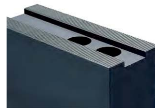
Spannbacken nach der Reinigung Serration after cleaning
