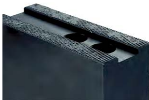
Spannbacken vor der Reinigung Serration before cleaning
