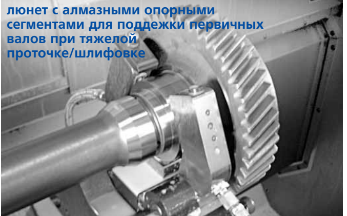
люнет для обработки валов в авиастроении
