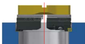
Twin edge boring
