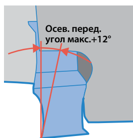
Криволинейная кромка с осев. перед. углом Макс. +12°
