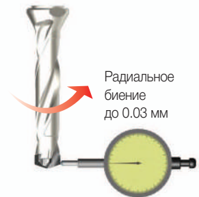
[Контроль вертикального оборудования]
