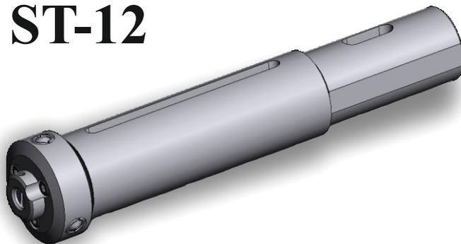
Алмазный выглаживатель для отверстий ST-12 применяется для отделочного выглаживания сквозных отверстий. Обработка осуществляется только за 2 прохода. Длина отверстия не ограничена. Возможно изготовление инструмента с увеличенной длиной обработки (до 1000 мм и более) Исполнения инструмента для диаметров обработки: Ø30, и больше. Внутренняя подача СОЖ
