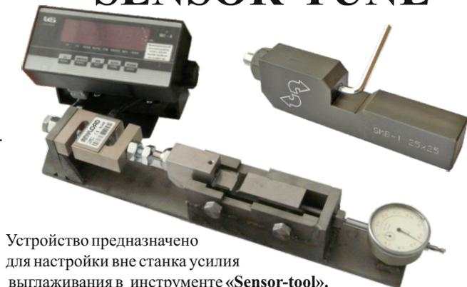
Устройство предназначено для настройки вне станка усилия выглаживания в инструменте «Sensor-tool». Диапазон регулировки от 50 до 1000Н с дискретностью 10 Н. (патент РФ №115281).
