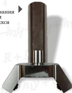
Выглаживатель с повышенным ресурсом со сменной пластиной из КНБ **ST-10**
