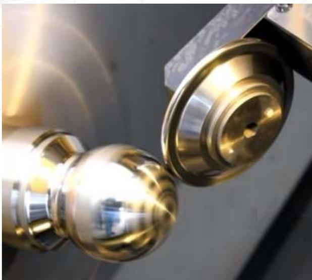
Обкатывание - вид механической обработки, целью которого является упрочнение поверхностного слоя детали, повышение его износостойкости и достижения 8-10 квалитета точности поверхности.
