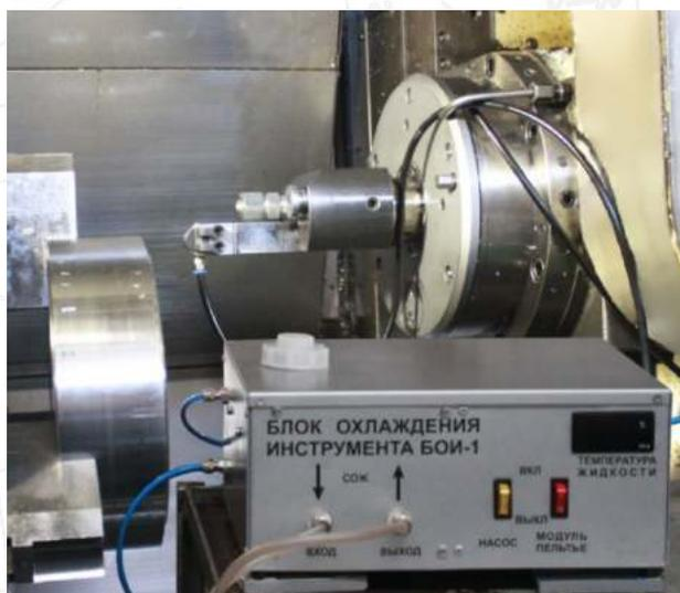
Высокая интенсивность теплоотвода достигается за счёт снижения температуры теплоносителя в замкнутом контуре, обеспечиваемого теплообменником со сборкой из четырёх ТЭМ Пельтье.
