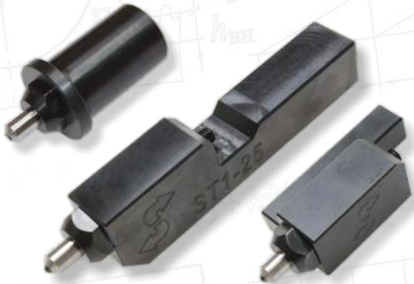
Особенностью алмазного выглаживания в отличие от других методов обработки поверхностным пластическим деформированием является применение в качестве демпфирующего элемента алмаза, который обладает следующими свойствами: чрезвычайно высокой твердостью, низким коэффициентом трения по металлу, высокой степенью чистоты, с которой может быть отполирован алмаз, высокой теплопроводностью.
