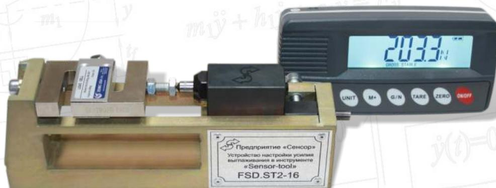
Устройство предназначено для настройки вне станка усилия выглаживания в инструменте «Sensor-tool». Диапазон регулировки от 50 до 1000Н с дискретностью 10 Н. Устройство настройки применяется для настройки на точное усилие пружины. Также устройство настройки будет полезно, если вы
