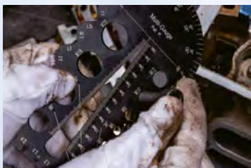
Измерительные отверстия Измерение основного диаметра болта
