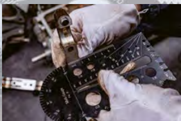
Быстрая проверка перпендикулярности измерительной ножки
