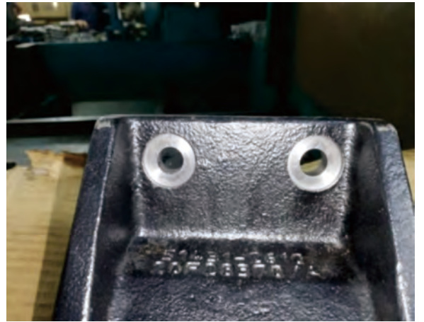
After back spot-faced test on forged steel (hole \Phi 13.1 spot faced \Phi 26.2 ) 단조강에 백 페이싱 작업후 사진 (홀 \Phi 13.1 , 페이싱 \Phi 26.2 )
